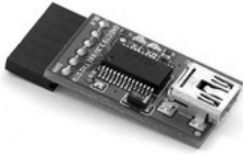
Bild 3.8: USB-Adapter mit FTDI-Chip (Quelle: Elmicro)
